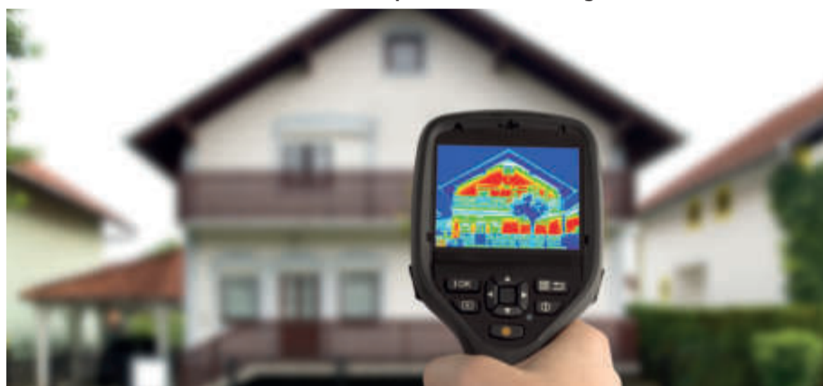
Die Wärmebildkamera zeigt, wo es im Haus energetischen Sanierungsbedarf gibt. Mit einer richtigen Dämmung können die Wärmeverluste vermieden werden.
